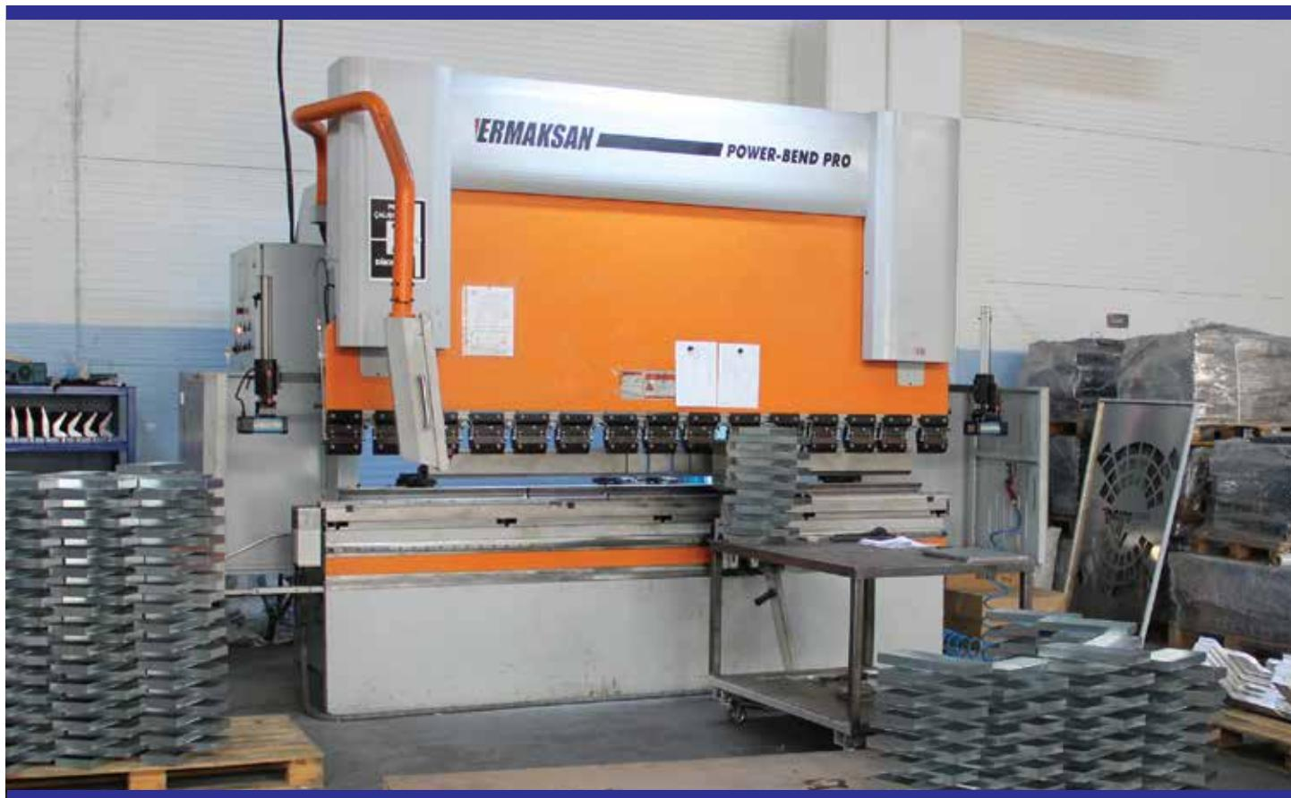
Firmamız 3000 mm boyunda ve maksimum 10 mm kalınlığında parça büükümleriyle hizmetinizde.
